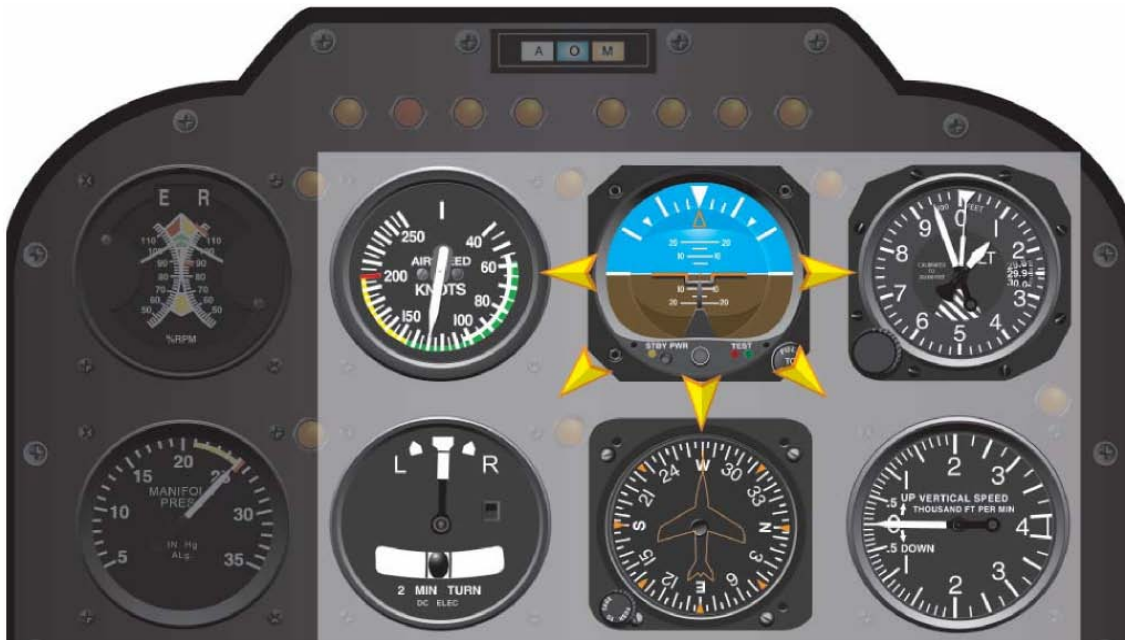
图 8-1 在大多数情况下，交叉检查多个仪表时都要检查地平仪。一次典型的交叉检查有可能会按如下顺序进行：地平仪、高度表、地平仪、升降速度表、地平仪、航向指示器、地平仪等。
