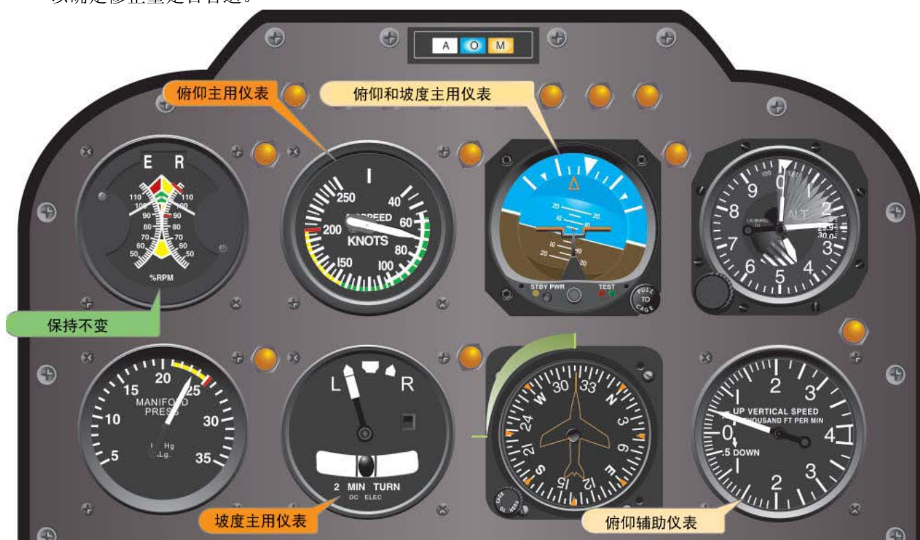
图 8-15 以恒速稳定爬升左转时的飞行仪表指示。
