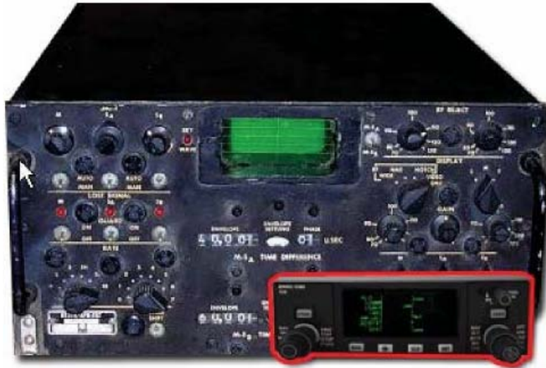
图 9-26 LORAN 第一次投入使用后军用飞机上的控制面板。接收机另外安装，重量超过 25 磅。大小为 6 倍的 LORAN 全集成接收机。在连续计算经度/纬度定位点的同时，计算机可以确定并显示：
