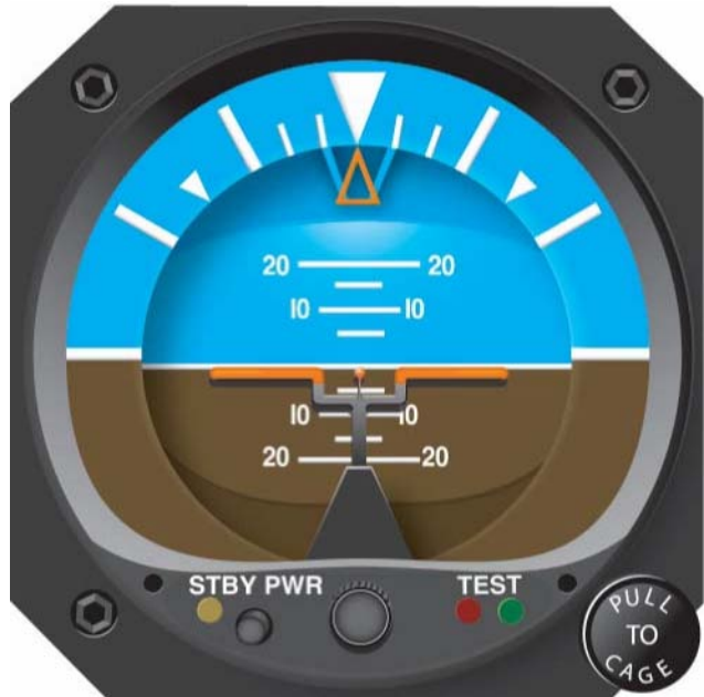
图 8-3 正常巡航时的初始俯仰修正量为小于等于地平线的宽度。
