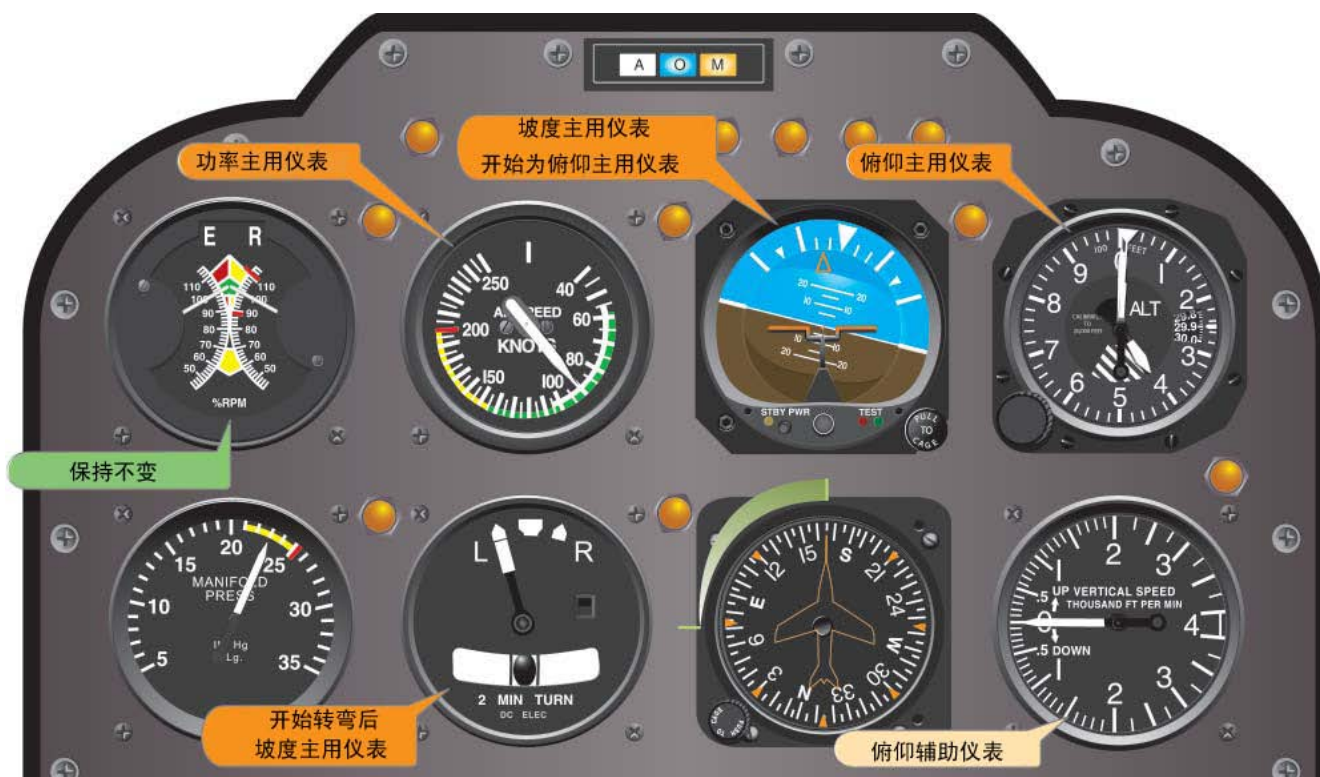
图 8-14 以标准速率左转时的飞行仪表指示。
