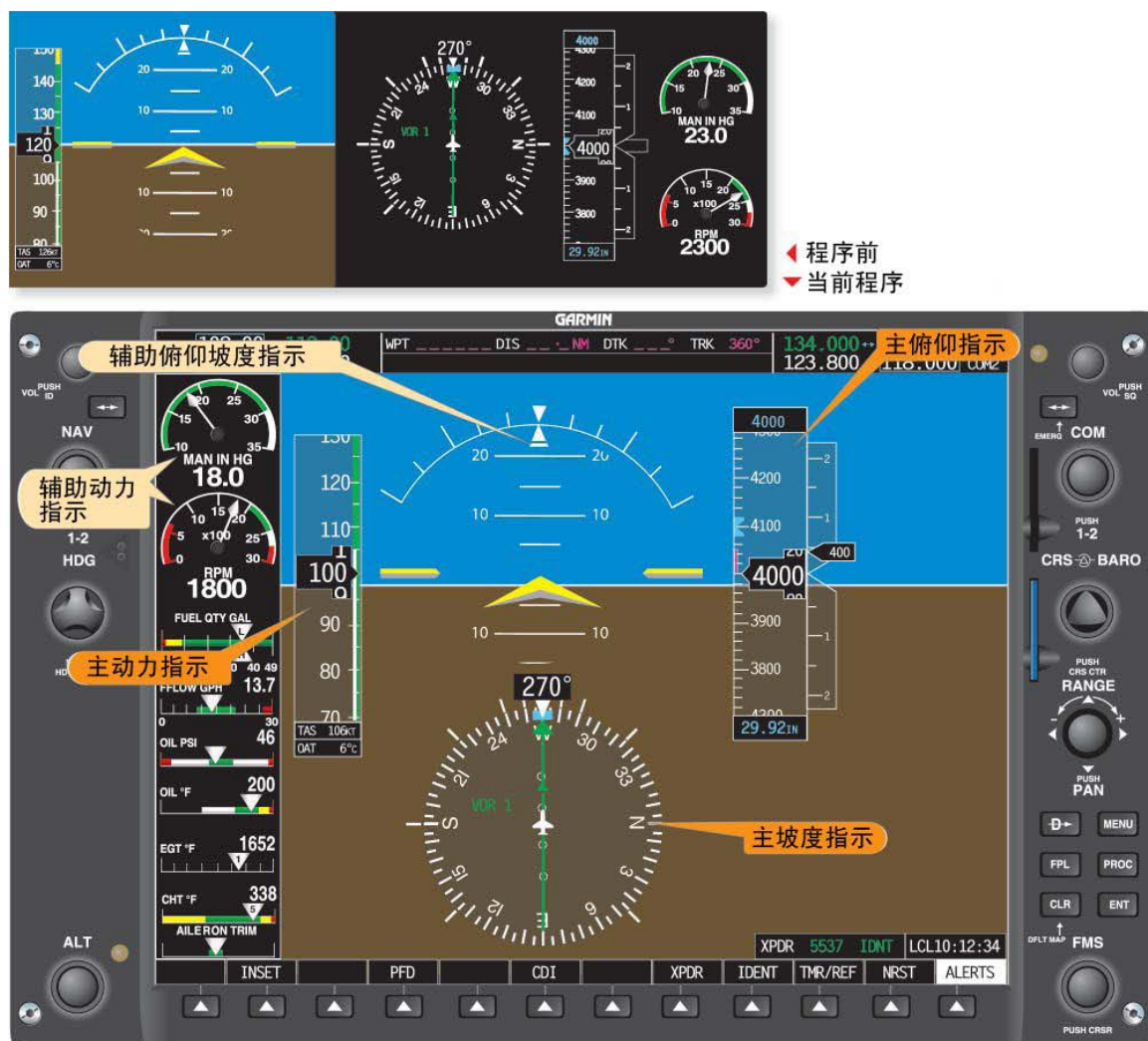
图 7-16 从已建立空速上的恒速爬升。
