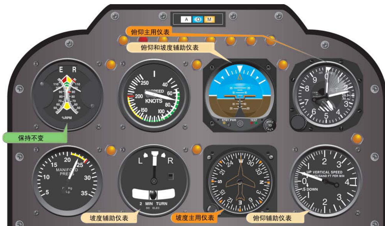
图 8-12 以恒速稳定爬升时的飞行仪表指示。
