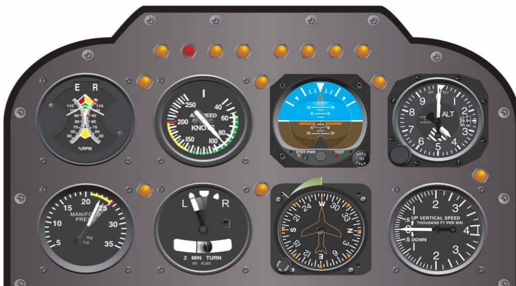
图 8-8 直线平飞过程中功率减小时的飞行仪表指示。
