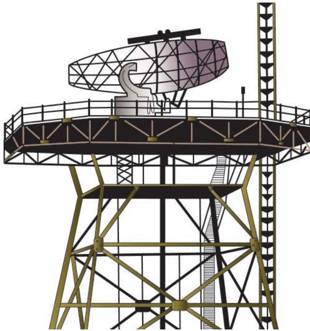
图 10-7 雷达和信标组合式天线
