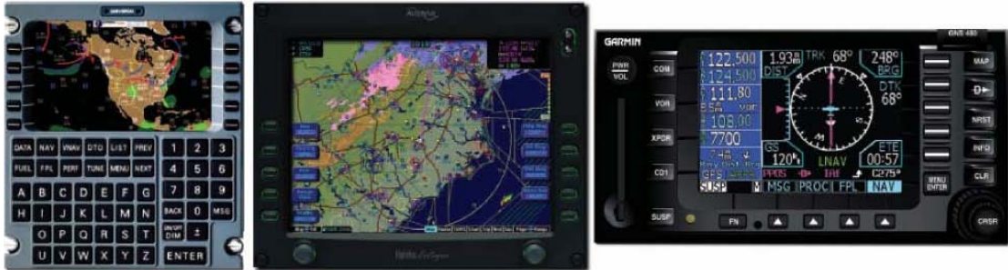
图 9-41 民航中典型的显示控制组件。Universal UNS-1（左）控制以及综合了其他所有系统。Avidyne（中间）以及 Garmin 系统（右）完整的综合了所有其他系统。虽然仍在小型通用飞机上可以发现 Universal CDU，但是 CDU 与单机系统性能上的差异每年都在逐渐缩小。
