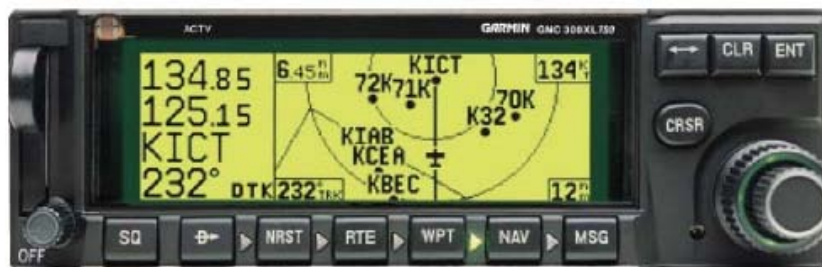
图 9-23 机载 RNAV 接收机发生了明显的改变。一般开始时, RNAV 接收机使用 VOR, 以及/或 DME 的数据进行计算。一般不会像本例中出现的情况。目前 GPS 例如 GNC300 以及 Bendix King 公司的 KLS 88 LORAN 接收机根据配备的数据库以及飞机的位置信息来计算航路点。
