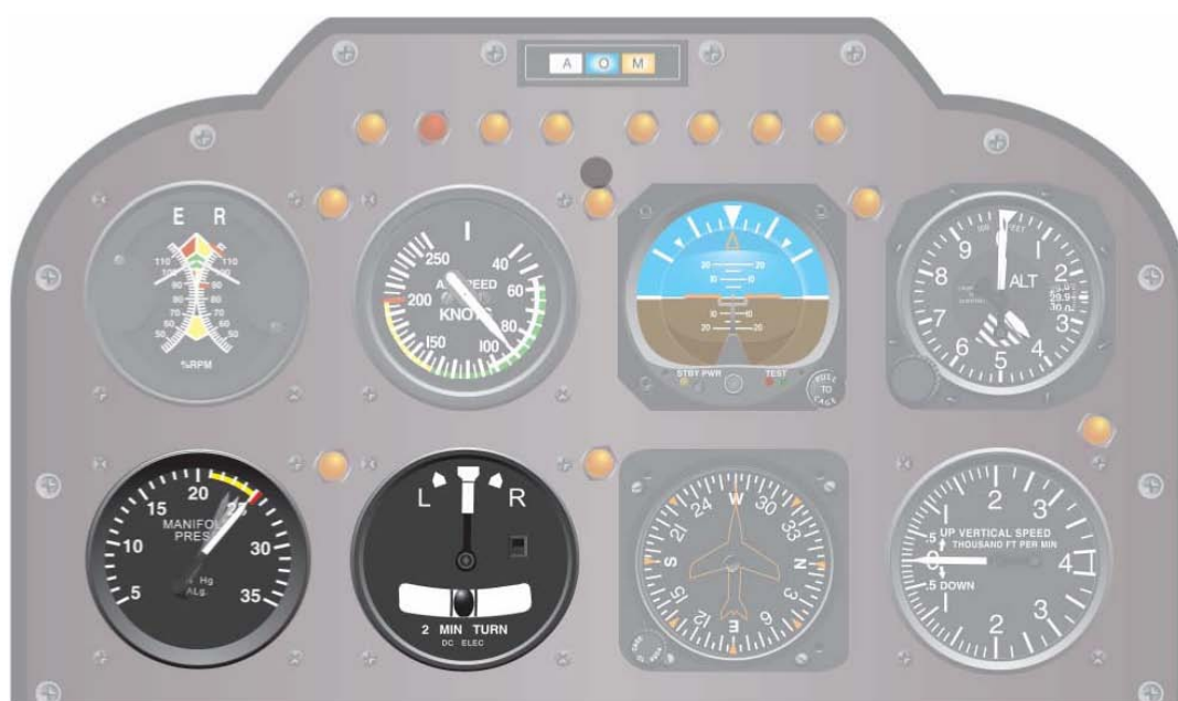
图 8-6 协调飞行状态由位于中间位置的小球指示。
