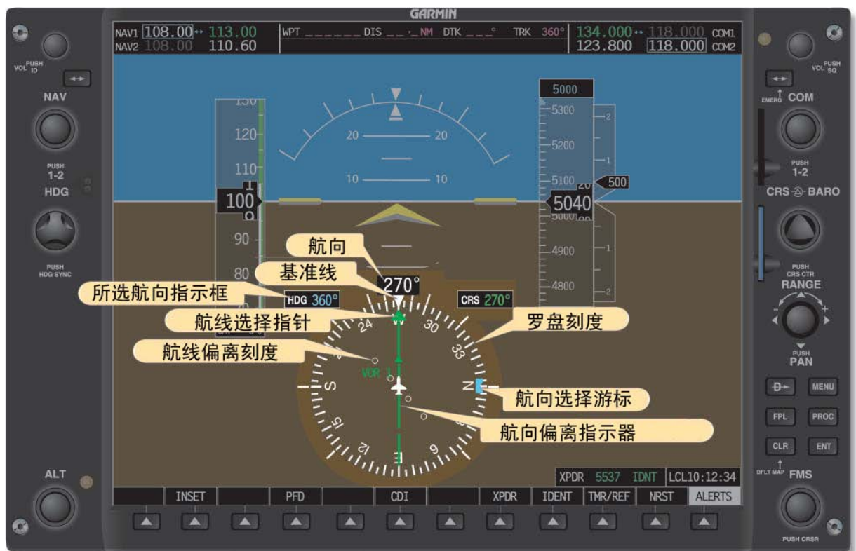
图 9-14 电子飞行仪表中飞行员主飞行显示（PFD）上的 HSI 显示。注意只对与 HSI 有关的进行标注。
