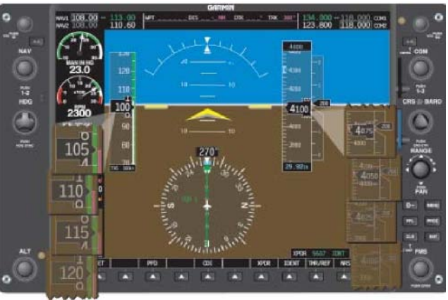
图 7-7 飞机在增加高度的同时空速下降。在这种情况下，飞行员已经降低了俯仰姿态。
