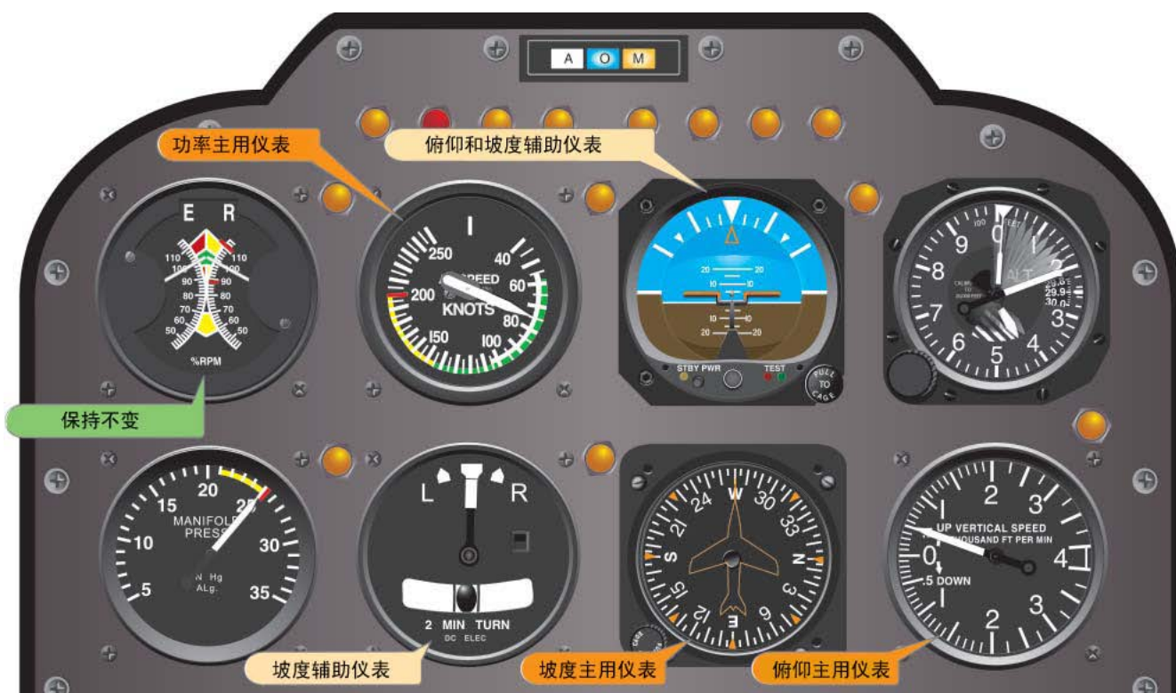
图 8-13 以恒定速率稳定爬升时的飞行仪表指示。
