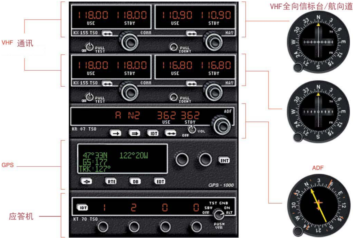
图 10-1 典型的导航/通讯（NAV/COM）设备布局.
