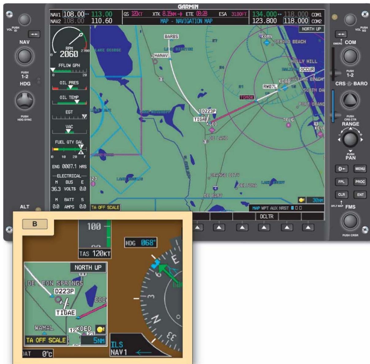
图 9-20 中显示相同的飞机在 ORM 径向线接近 TIGAE 交叉点转向向台航道。
