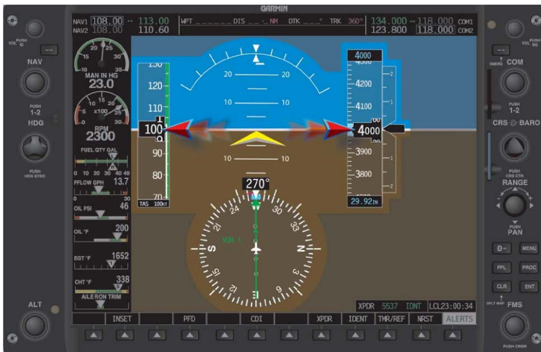
图 7-14 飞行员过分专注于俯仰姿态和高度，而未注意到坡度指示。注意趋势线到了左边。
