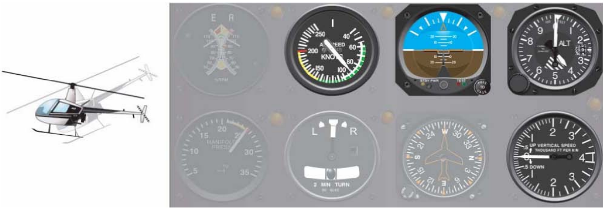
图 8-2 俯仰操纵中使用的仪表有：空速表、地平仪、高度表以及升降速度表。
