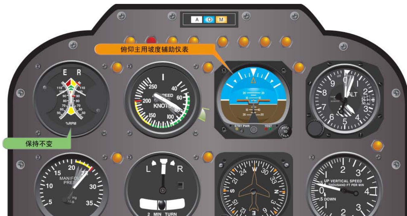
图 8-11 进入恒速爬升时的飞行仪表指示。
