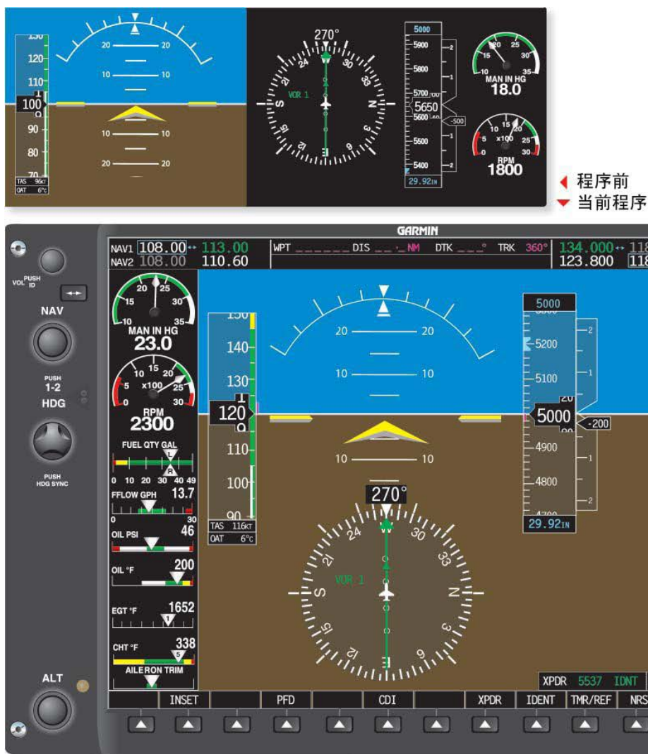
图 7-18 顶部图像表示功率减小，以 500FPM 下降到高度 5000 英尺。底部的图像表示功率增加，改平开始。
