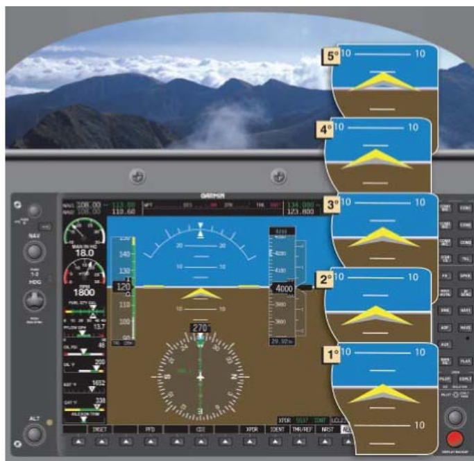
图 7-3 各种俯仰姿态（右边），飞机显示水平飞行。
