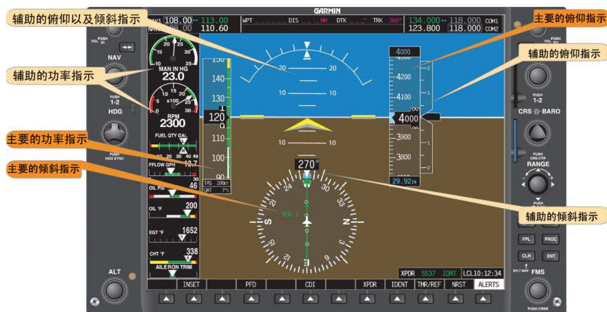
图 7-9 直线平飞（正常巡航速度）。
