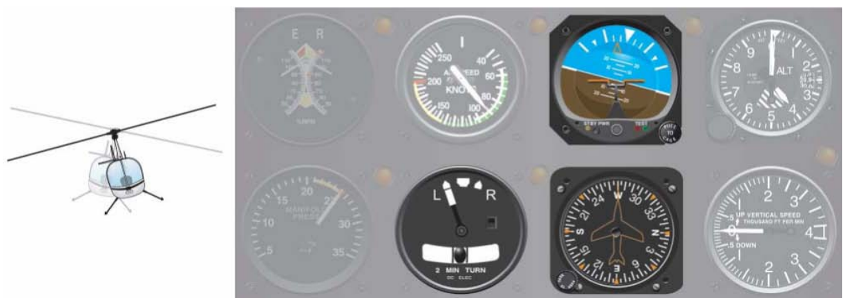
图 8-4 用于坡度操纵的飞行仪表有：地平仪、航向指示器以及转弯指示器。
