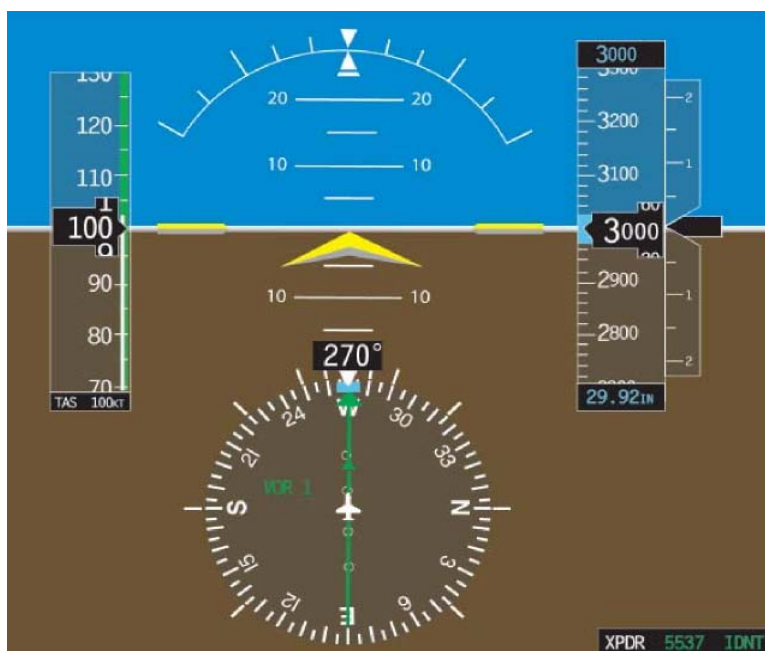
图 8-17 直线平飞时的 PFD 指示。
