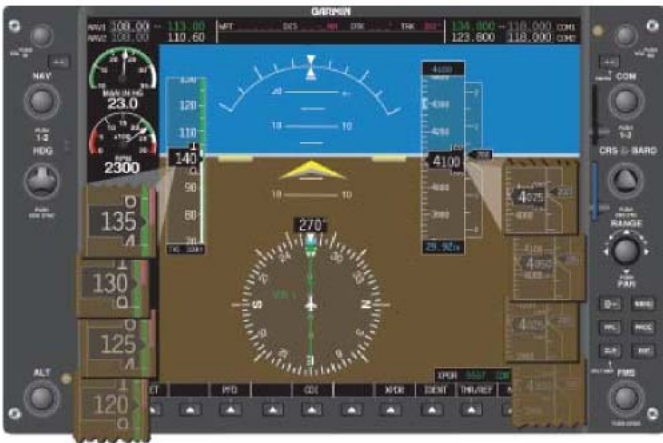
图 7-8 单独地进行俯仰姿态调整是不够的，如图显示速度和高度都在增大。这种情况时，减小功率也是有必要的。
