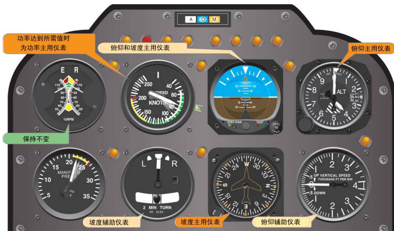
图 8-10 直线平飞过程中空速减小时的飞行仪表指示。
