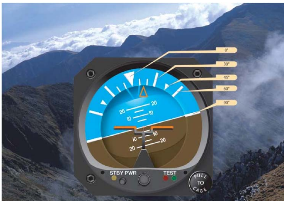
图 8-5 地平仪上方的坡度刻度指示坡度的度数变化。本范例中，直升机向右带有大约 15°的坡度。
