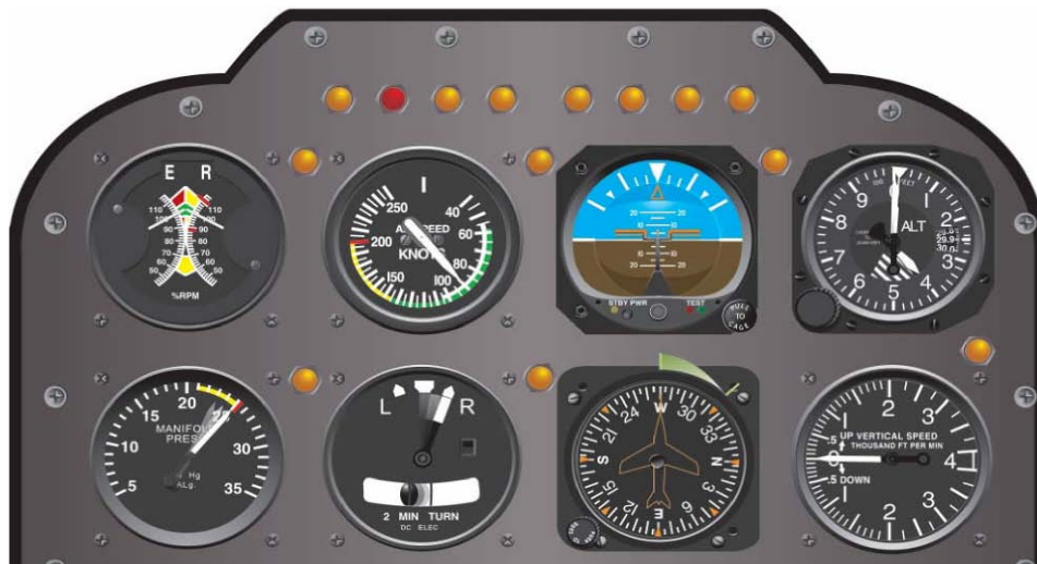
图 8-7 直线平飞过程中功率增加时的飞行仪表指示。
