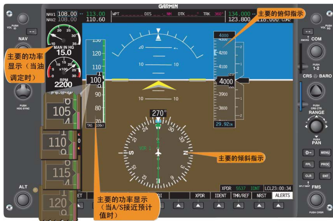
图 7-10 直线平飞（空速正在减小）。
