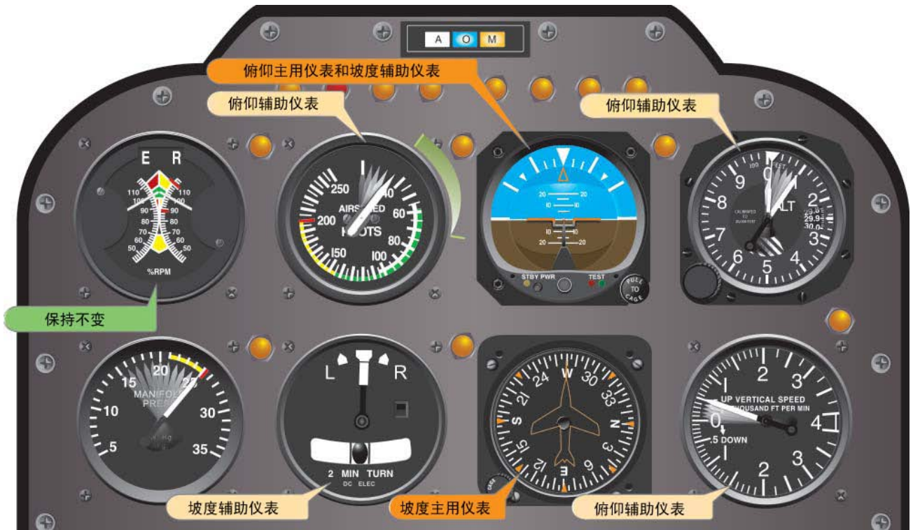
图 8-16 一次仪表起飞时的飞行仪表指示。
