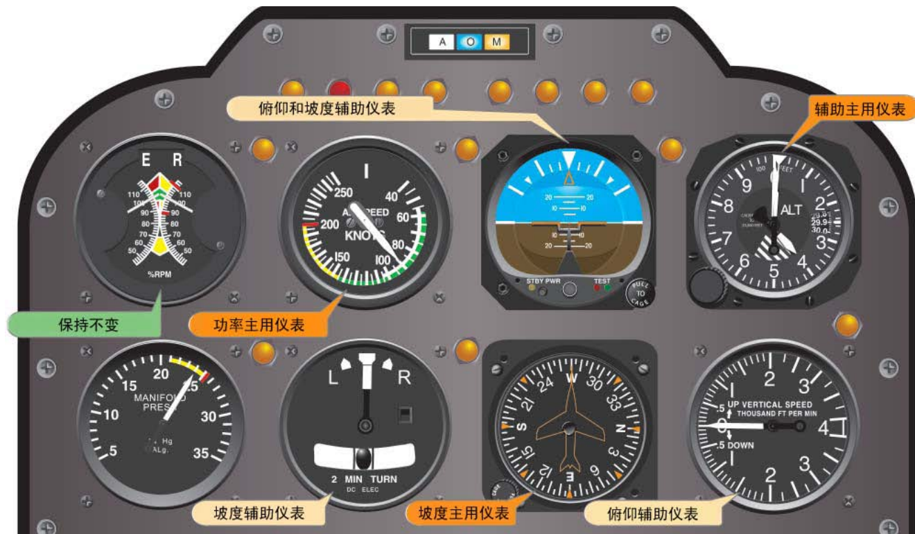
图 8-9 以正常巡航速度直线平飞时的飞行仪表指示。
