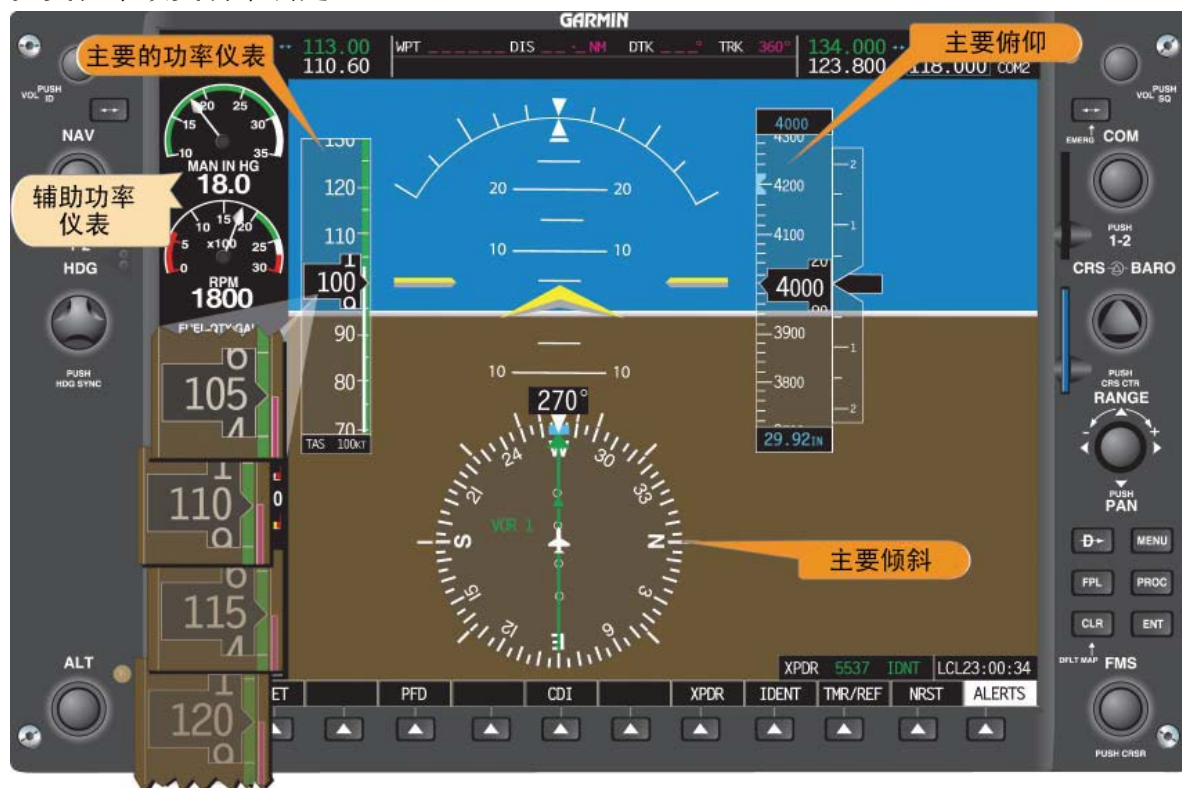
图 7-11 直线平飞（减小的空速稳定时）。
