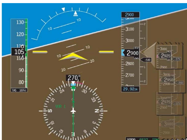
图 8-18 右转过程中俯仰姿态为机头向下时的 PFD 指示。
