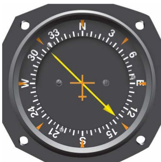
图 9-4 固定刻度指示器上指示的相对方位 (RB) 注意，刻度盘上总是指示 360 度或向北方向。在这种情况下，相对于导航台的方位为向右 135 度。如果飞机的磁航向为 360 度，那么磁方位 (MB) 也为 135 度。
