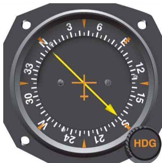
图 9-3 移动式刻度指示器上指示的相对方位 (RB) 通过将飞机的磁航向 (MH) 调定在顶部指标下方 045 度，磁方位 (无风的情况下) 就是相对方位 (RB) 向右 135 度，这样会指引飞行员
