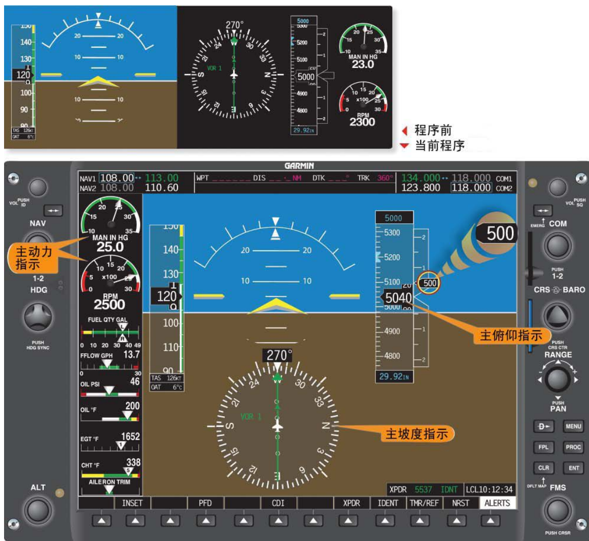
图 7-15 从巡航速度上的恒速爬升。
