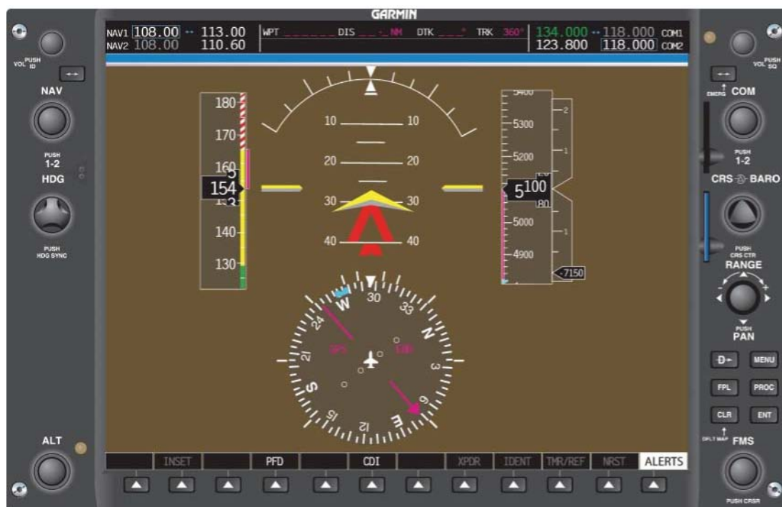
图 7-22 在 27°，天地线开始向上移动。注意蓝天在 17°机头下俯时保持可见。
