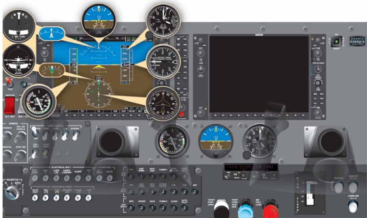
图 5-1 和主飞行显示（PFD）相对应的指针式仪表。
