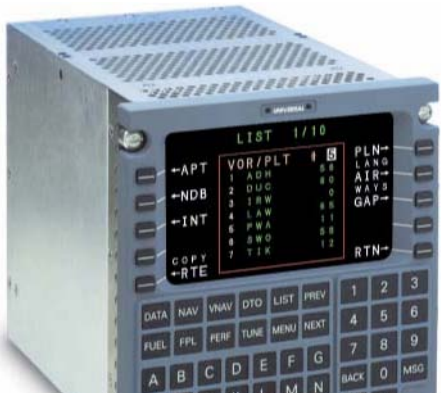
图 3-43 控制显示组件（CDU）用来控制飞行管理系统。
