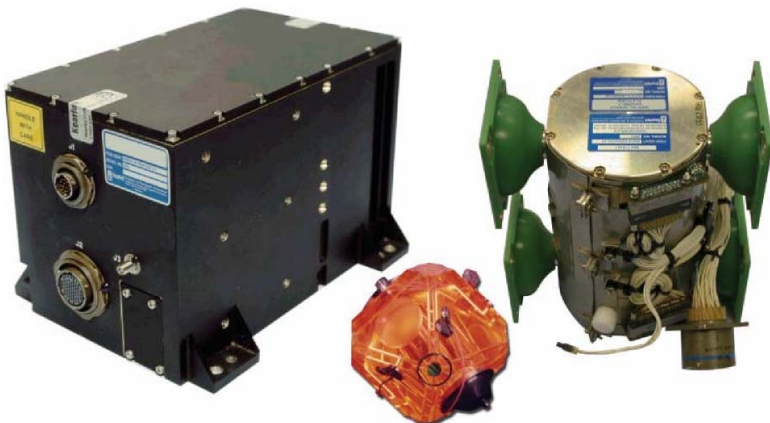
图 3-35 左侧为 Kearfott 姿态航向基准系统（AHRS）配合使用单片环行激光陀螺（MRLG）（中间）该设备放置在右侧的惯性传感器组件内（ISA）。
