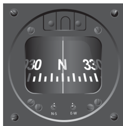
图 3-16 磁罗盘上的垂直线被称为基准线。
