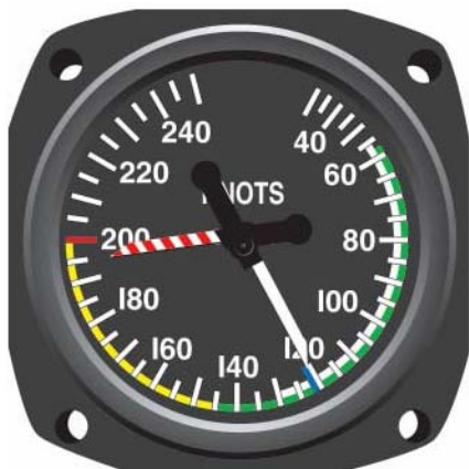
图 3-14 最大允许空速指示器有一个可移动的指针用来指示绝对不允许超过的速度，从而避免激波的产生，该速度随着高度的变化而变化。
