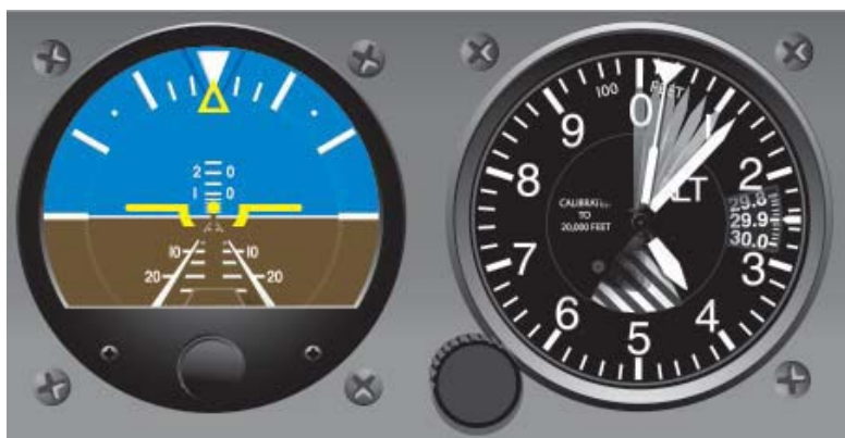
图 6-5 使用高度表来解释俯仰姿态，高度高意味着机头俯仰姿态高。
