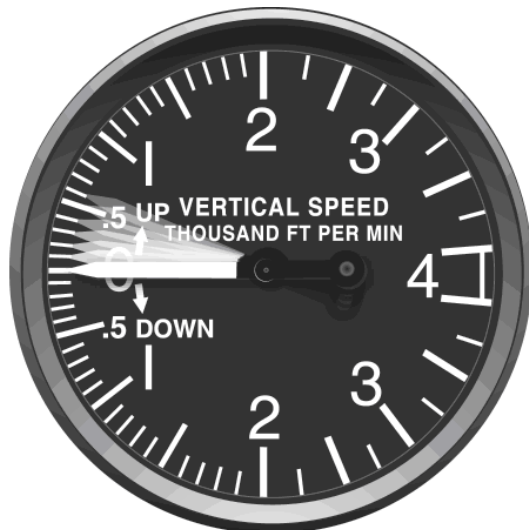
图 4-8 垂直速度指示器。
