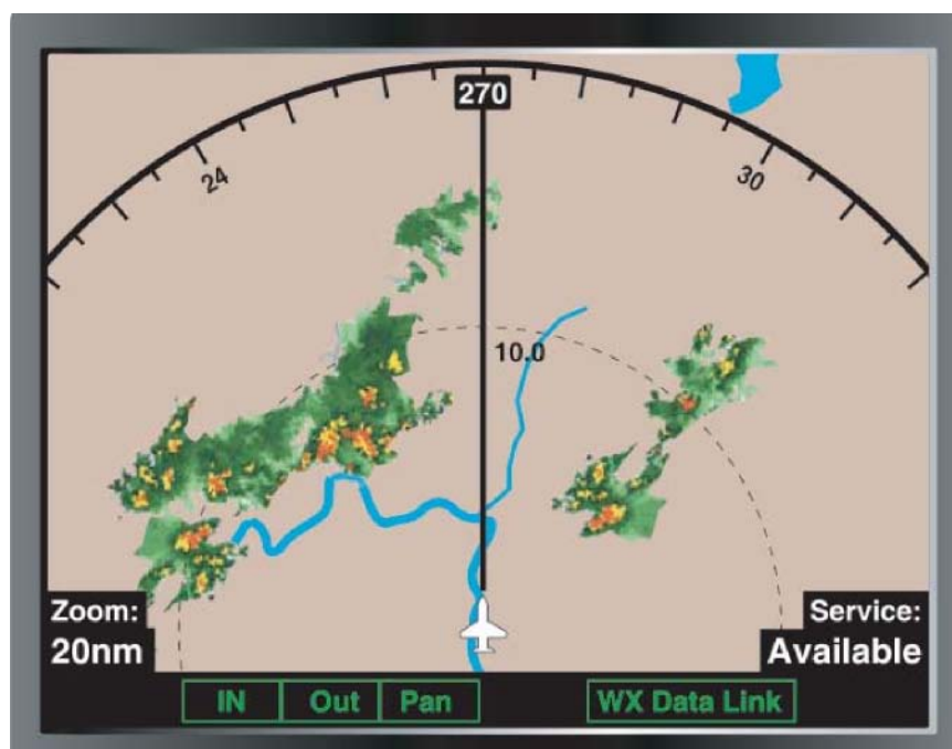
图 3-49 装有 ADS 的飞机有上传并显示气象信息的能力
