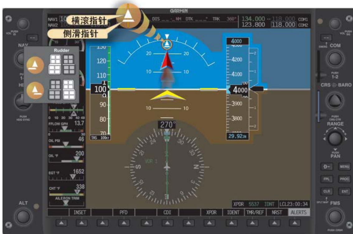
图 5-15 坡度指针和侧滑指示器。
