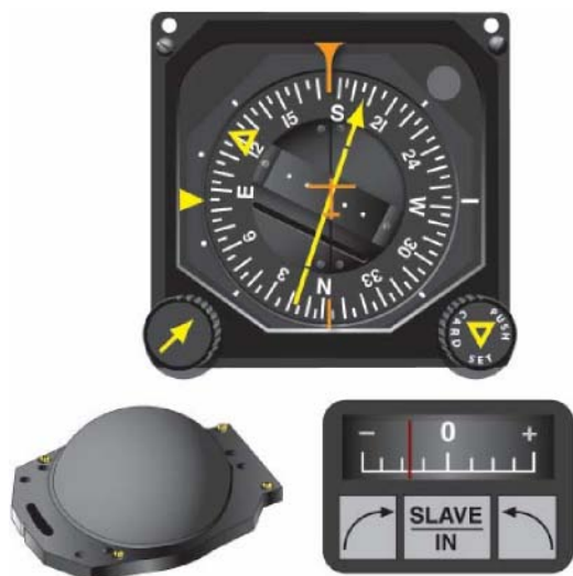
图 3-24 图示导航指示器（HIS 上），辅助控制以及补偿组件。
