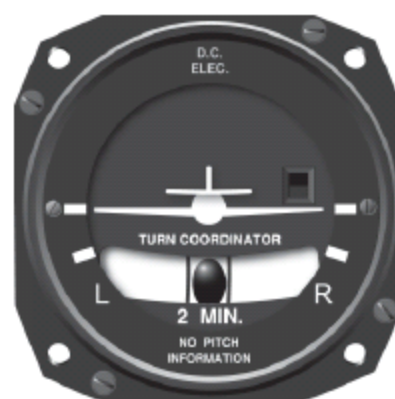
图 3-34 转弯调谐仪感应绕着横滚以及偏航轴的转动。
