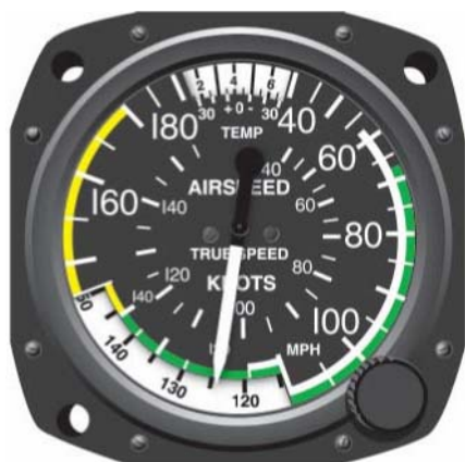
图 3-12 真实空速指示器允许飞行员对非标准温度以及大气条件下的 IAS 进行校准。
