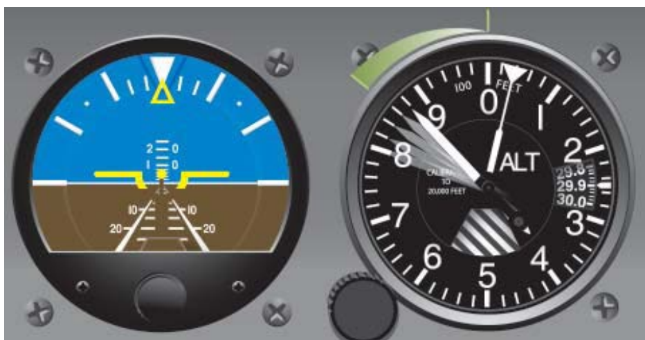
图 6-10 俯仰修正，超过 100 英尺——最初使用一个条宽进行修正。
