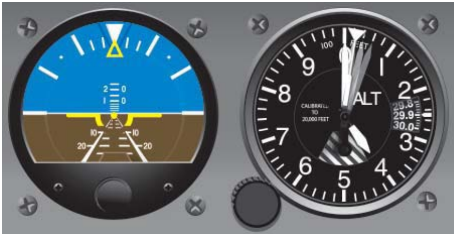
图 6-8 俯仰修正，小于 100 英尺——降低半个条宽来修正高度误差。
