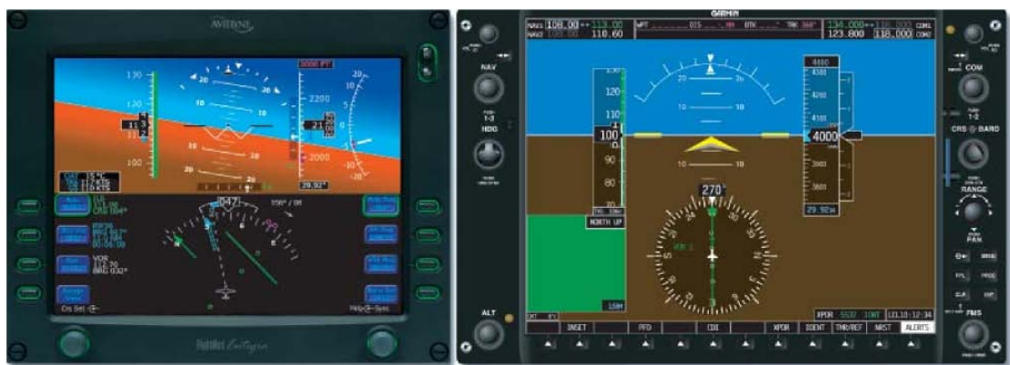
图 3-44 两个主飞行显示（左侧为 Avidyne 右边为 Garmin）。
