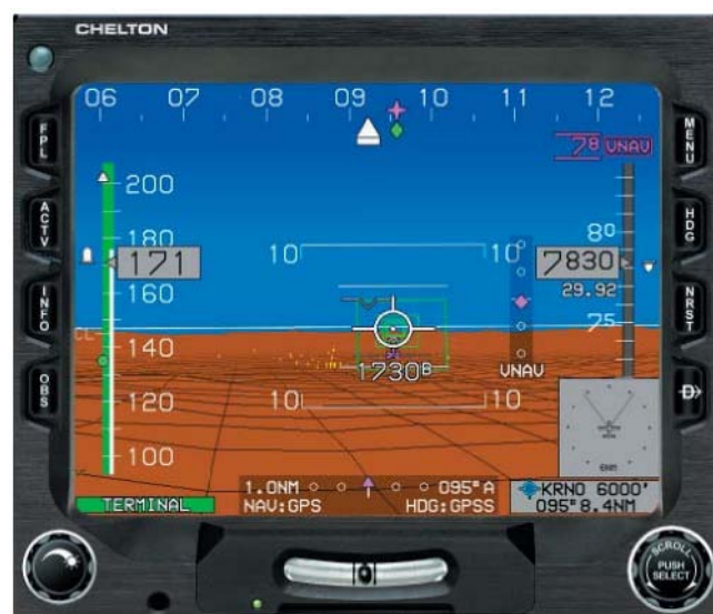
图 3-45 Chelton 飞行系统公司制造的合成视景所呈现的真实图像可视化的优势。该系统为飞行员实时提供真实的飞机三维图，以及飞机相对于周围地形的位
