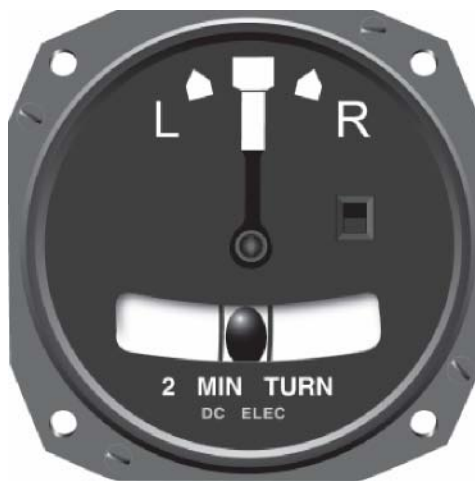
图 3-32 转弯侧滑仪。
