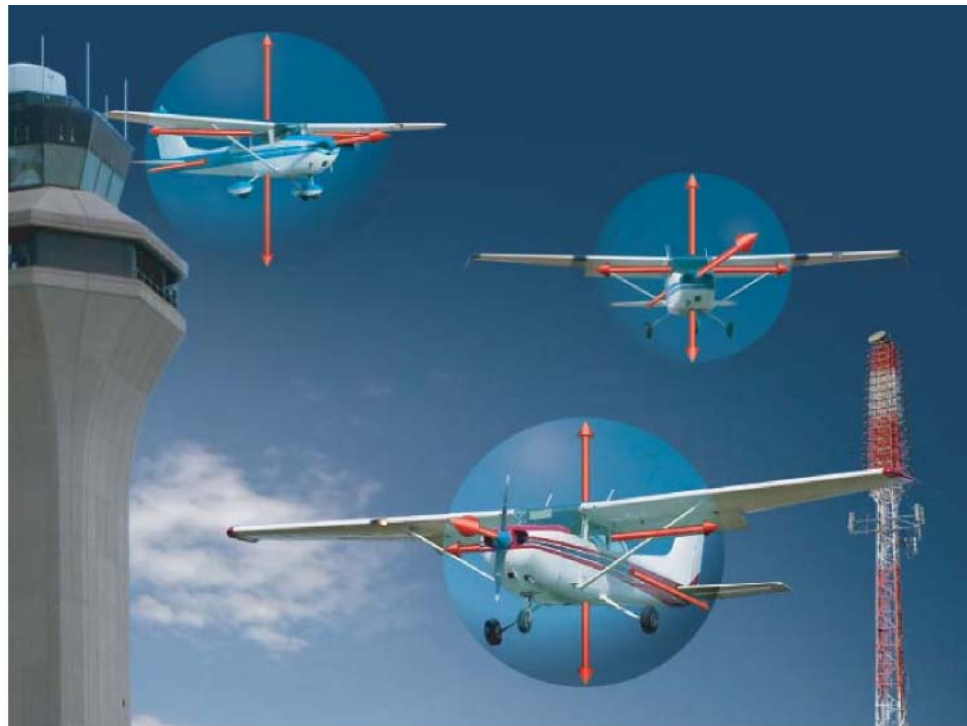
图 3-47 配备了广播式自动相关监控（ADS-B）的飞机可以连续对他们的识别码，高度，方向以及升降趋势进行广播。发射的信号向其他飞机以及相关的地面站传输了非常重要的信息。其他配备了 ADS 的飞机可以接收该信息并且可以使用多种方式来对信息进行处理。在相对比较饱和的环境中（假设所有飞机都配备了 ADS），这些系统可以为各自飞机预计航迹，并向其他飞机发送预计的航迹信息，从而大大增强了防撞能力。同时，还有一种名为自动相关监控-寻址（ADS-A）的系统详细信息可以参见飞行员航空知识手册。
