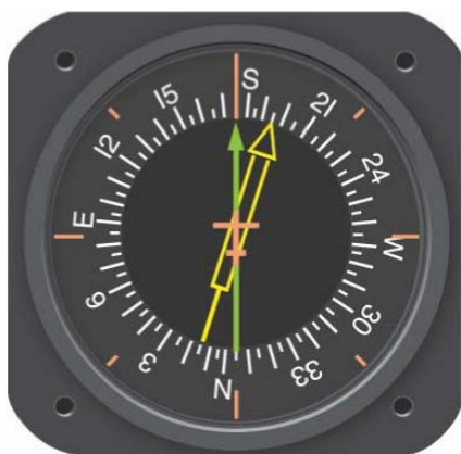
图 3-24 图示导航指示器（HIS 上），辅助控制以及补偿组件。
