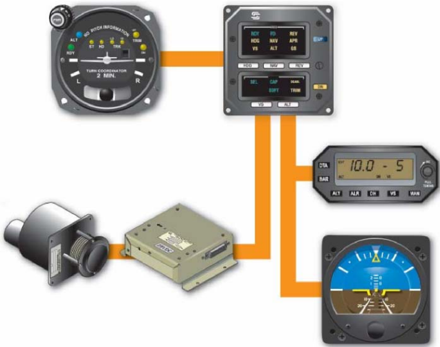
图 3-42 S-Tec 公司生产的自动驾驶的布置图。
