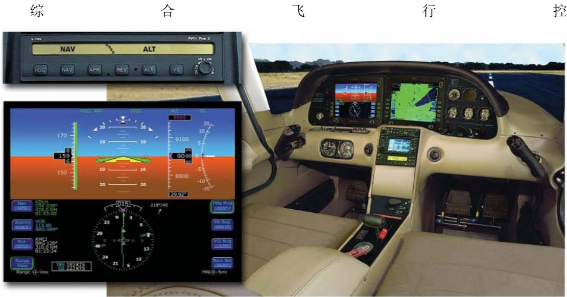
图 3-40 Cirrus 飞机上安装的 S-TEC/Meggitt 公司综合自动驾驶仪。
