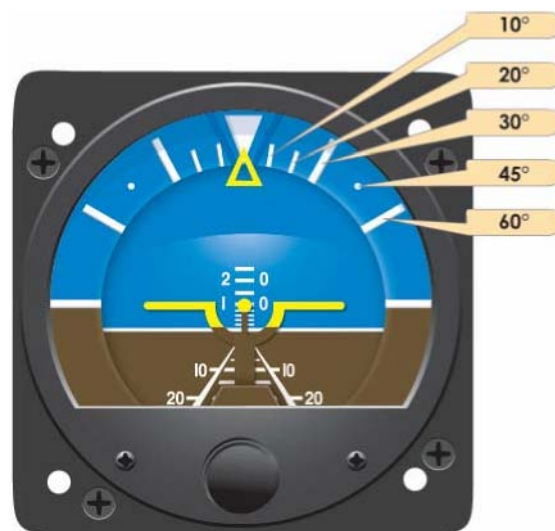
图 3-29 姿态指引仪的刻度盘，基准线来指示俯仰以及横滚。
