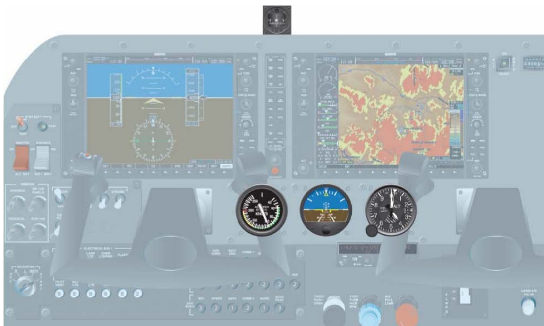
图 5-4 备份的空速表、地平仪和高度表。
